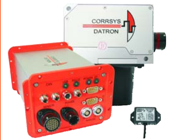
CORREVIT® S-350 Aqua Sensor mit Kreisel zur automatischen Berechnung des Schwimmwinkels bezogen auf den Fahrzeugschwerpunkt
