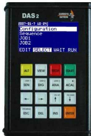
Fig. 3: DAS control/display unit
